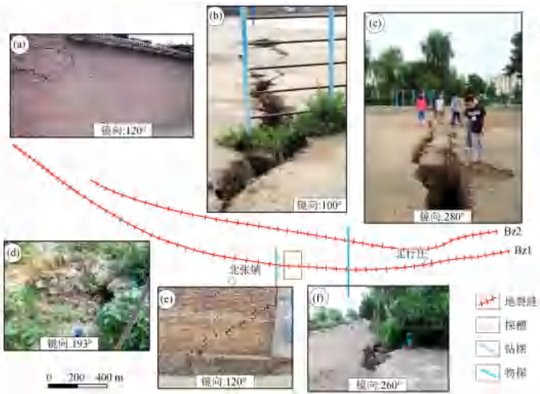
图3 北张地裂缝平面分布及典型照片
