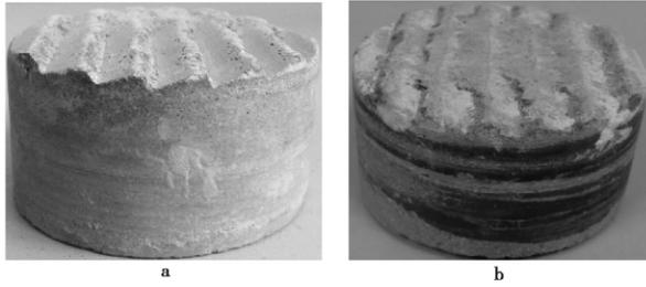
图8 剪断破坏与滑移破坏示意图
